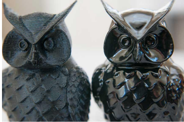
Figura 13- Un oggetto stampato in 3D, prima e dopo la lisciatura a vapore. Fonte: www.geeetech.com
