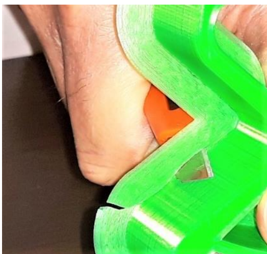
Figura 11- Rimozione delle tese
